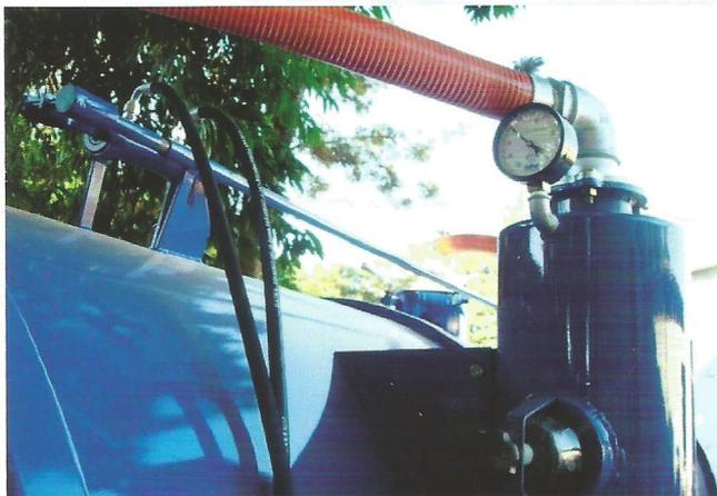
Pistão hidráulico e monovacuumetro
