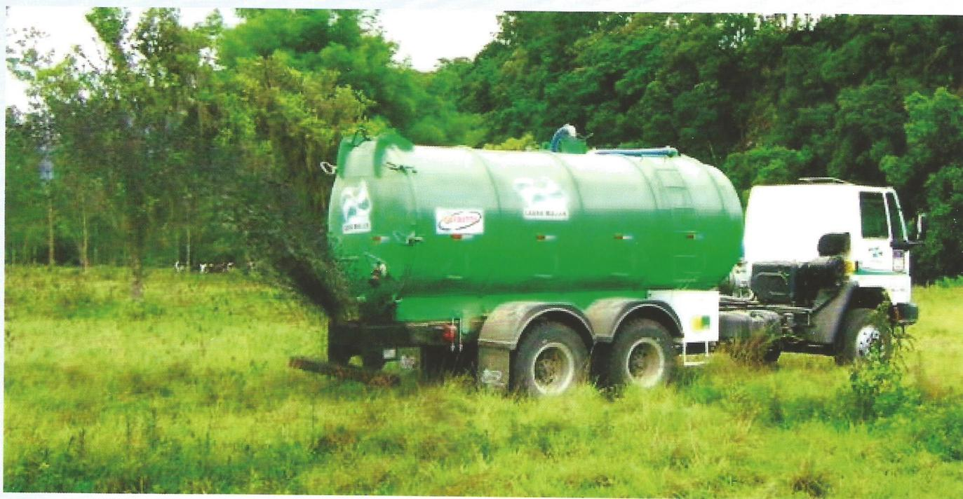
Equipamentos para coleta e distribuição de dejetos suínos, bovinos e demais misturas líquidas ou pastosas. Alta produção de vácuo, com capacidade de sucção de até 08 metros de profundidade à mais de 50 metros do ponto de coleta.
