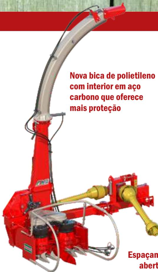
**Nova bica de polietileno com interior em aço carbono que oferece mais proteção**
